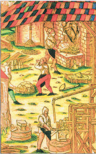
Ansicht eines Eisenhammers in der Frühen Neuzeit; ganz im Vordergrund geschieht das Ausschmieden der Luppe unter dem Hammer (aus: G. Agricola, De re metallica, Buch XII, Basel 1556).
