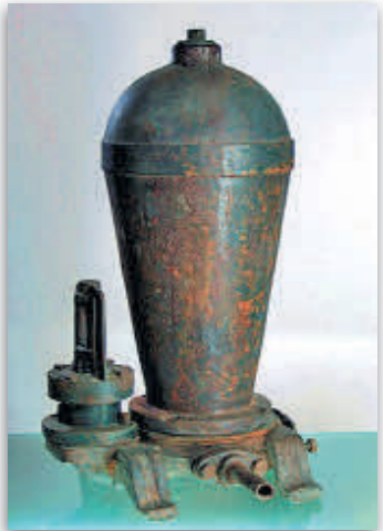
Ein Hydraulischer Widder aus dem Widdermuseum in Oberneukirchen (Bayern); Aufnahme N. Samweber
